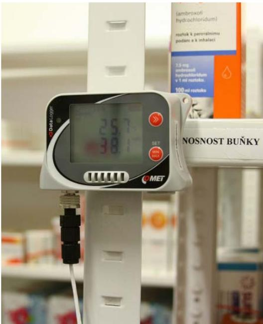
Los registradores CHR-0111/0121/0141 están diseñados para el registro y medida directa de temperatura en 1, 2 ó 4 canales externos PT1000. Disponen de una memoria con capacidad de registro de hasta 500.000 valores. Las medidas registradas en memoria pueden ser descargadas a un PC vía interfase USB-C y proceder a su posterior tratamiento con el software CHA-R004.
